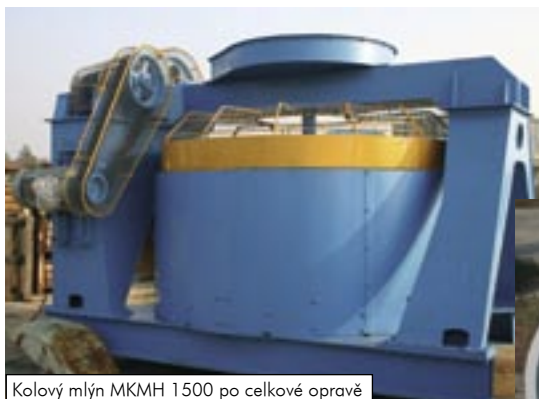
Kolový mlýn MKMH 1500 po celkové opravě
