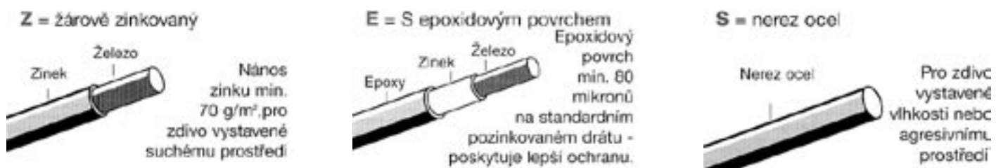
Obr. 9-11 Typy povrchové úpravy výztužných prvků MURFOR®
